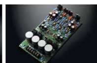
Цифровые/аналоговые платы со встроенными источниками питания
