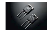
Полевые МОП-транзисторы с одинаково распределенной полярностью
