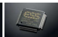
Высокоэффективный 32-бит Ц/А преобразователь ES9018
